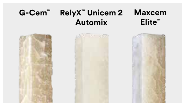
Risultati del test di sollecitazione sui cementi compositi autoadesivi. Tutti i campioni sono stati lasciati polimerizzare chimicamente e sottoposti a 10.000 cicli termici.
